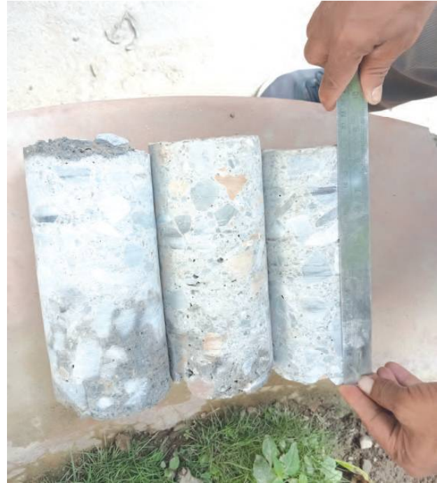
नौविसे दोभान लिखु सडक ढलानको Core Cutting को Sample को नाप
